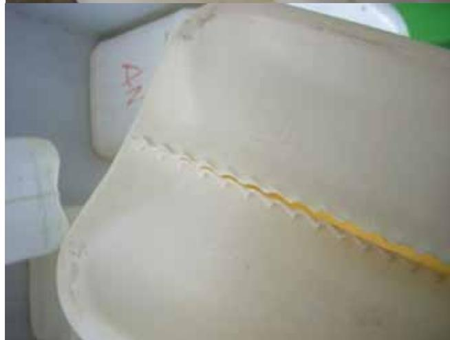
Rotura de la junta por efecto de líquido patrón.
