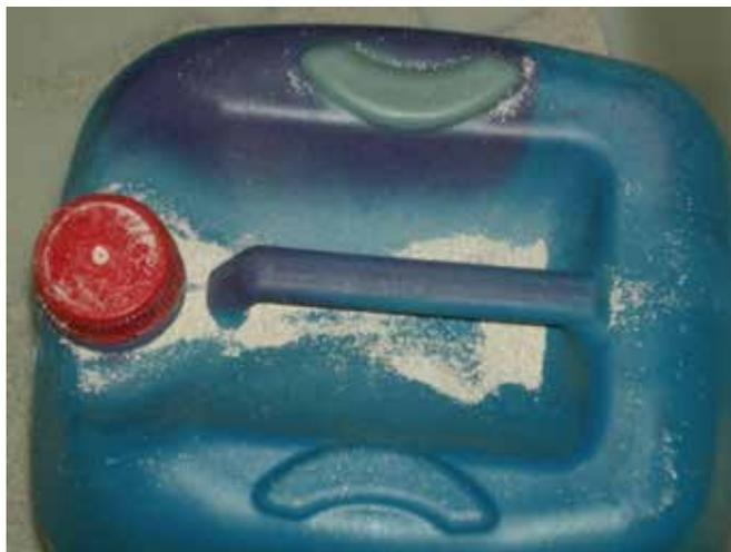
*Degradación de un envase de polietileno frente al ácido nítrico en un ensayo de compatibilidad química.*
